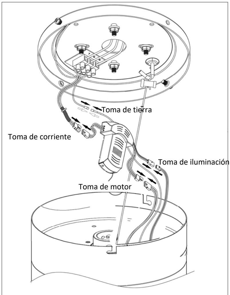
5.- Fijar el ventilador al soporte del techo
