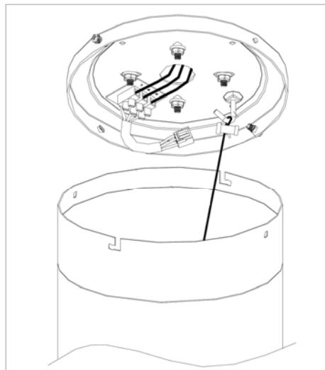
4 - Conect the fan cables to the module
