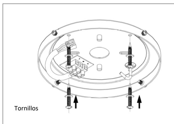
INSTALACIÓN EN TECHO DE CEMENTO
